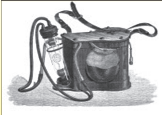
1862 Lampe électrique de mineur Dumas et Benoît
